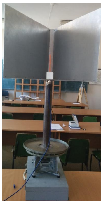
Рисунок 3.13 – Установка антенны на ПУ
