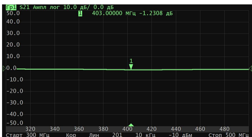
Рисунок 3.7 – Частотная зависимость коэффициента передачи S_{21}
