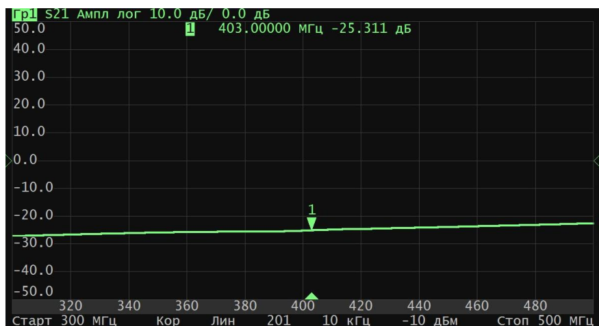
Рисунок 3.8 – Частотная зависимость коэффициента передачи S_{21} при отсутствии напряжения на pin диоде
