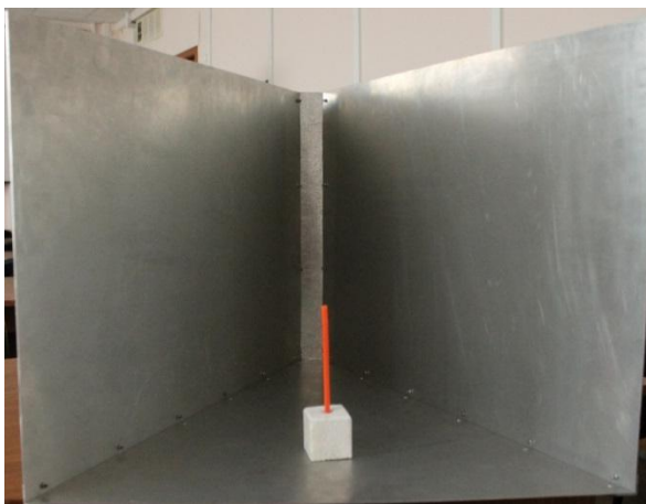
Рисунок 3.12 – Макет угла секторной антенны
