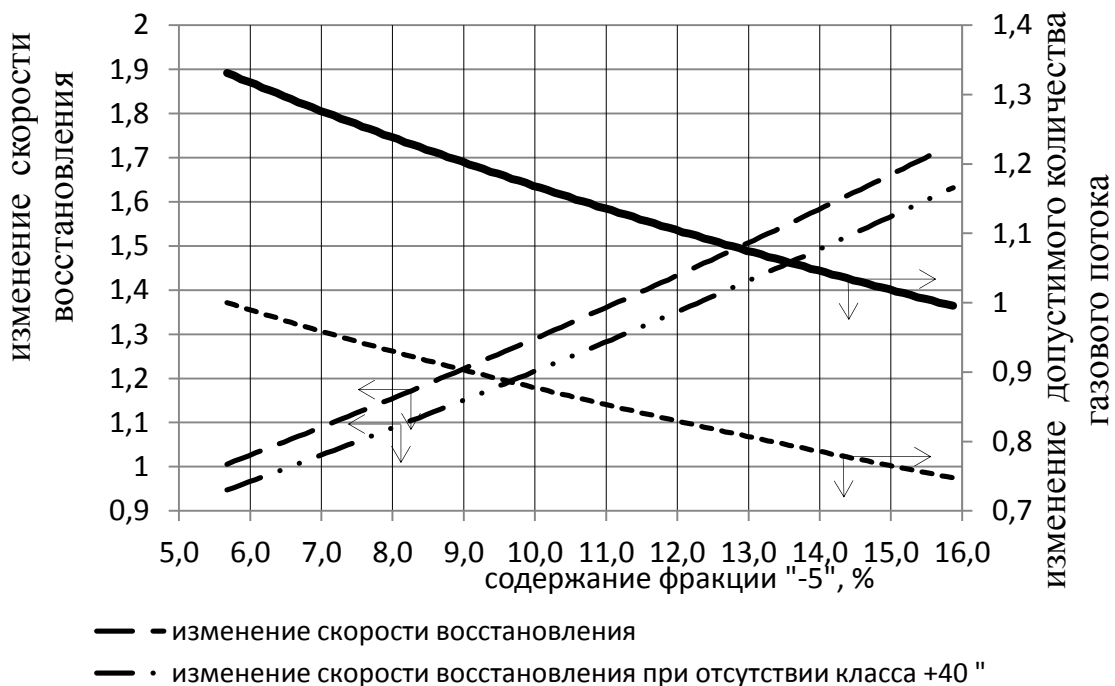
Рис. 3. Изменение скорости восстановления шихтовых материалов и количества газового потока от гранулометрического состава
