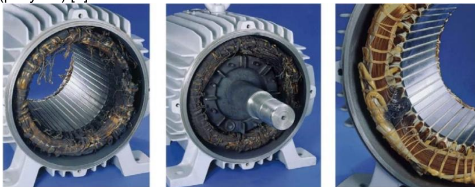
Рис. Пробой изоляции обмоток статора АД
