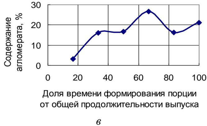
Рис. 1. Содержание окатышей (а), коксового орешка (б) и агломерата (в) по мере истечения их из бункера БЗУ в смеси друг с другом, при суммарном расходе добавок 1,6 кг и расположении их под агломератом
