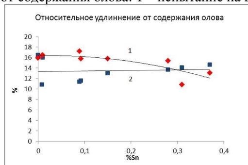
Рис.3. Зависимость  $\delta_5$  от содержания олова: 1 – испытание в 3,5%-NaCl; 2 – на воздухе
