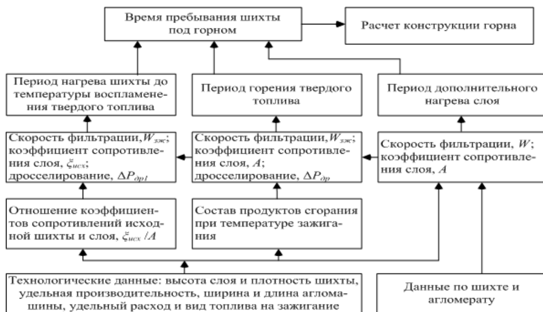
Схема расчета скоростей фильтрации и величины дросселирования вакуум-камер под горном
