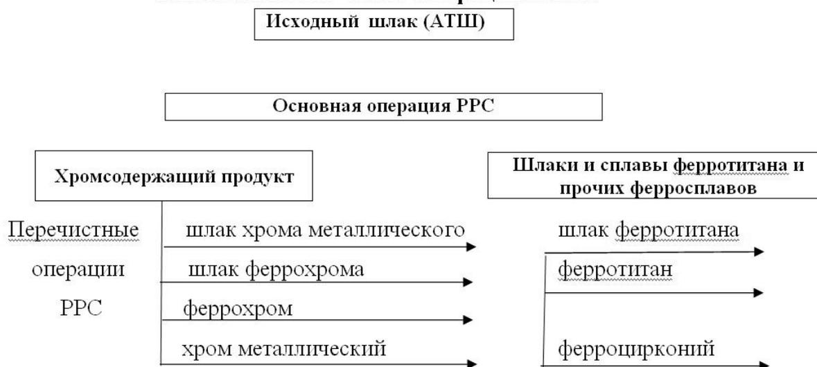
Рис. 1. Технологическая схема сепарации шлака
