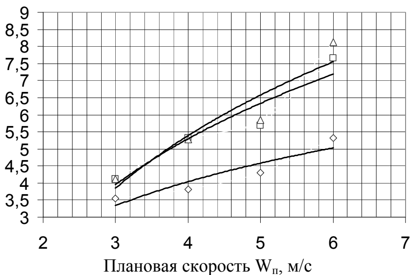
Рис. 3. Зависимость коэффициентов массоотдачи от плановой скорости в противоточном циклоне при нескольких проходах высушиваемого материала через циклон: \Delta – один проход через циклон; \square – два прохода через циклон; \diamond – три прохода через циклон
