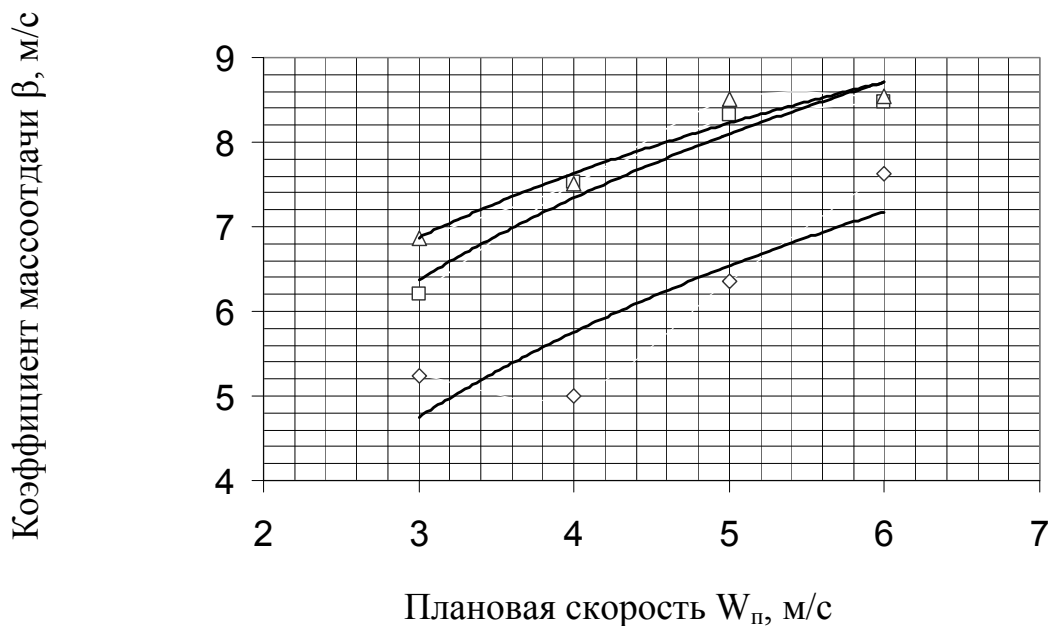
Рис. 2. Зависимость коэффициентов массоотдачи от плановой скорости в прямоточном циклоне при нескольких проходах высушиваемого материала через циклон: \Delta – один проход через циклон; \square – два прохода через циклон; \diamond – три прохода через циклон
