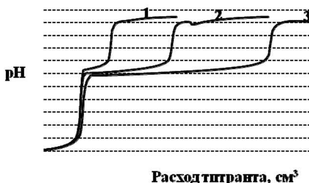
Рис. 1. Потенциометрическое титрование сульфата кадмия в зависимости от его концентрации: 1 –  $5 \text{ г/дм}^3$ , 2 –  $15 \text{ г/дм}^3$ , 3 –  $30 \text{ г/дм}^3$ .
