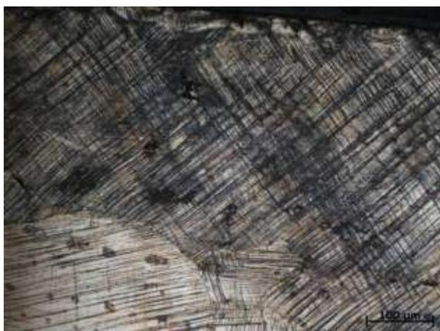
*Рис. 3* – Структура стали после 20 % деформации.
