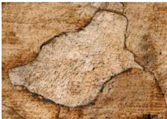
*Рис. 1-* Структура стали 110Г13Л после закалки.
