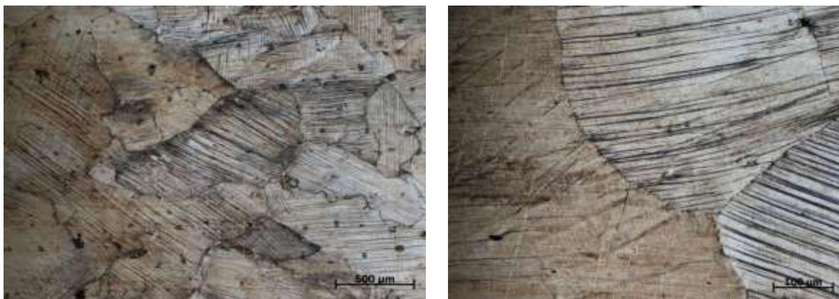
*Рис. 2* – Структура стали Гадфильда после 20 % деформации.
