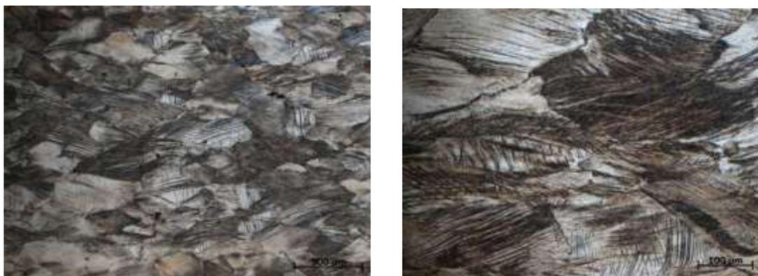
*Рис. 4 - Структура стали после 40 % деформации.*
