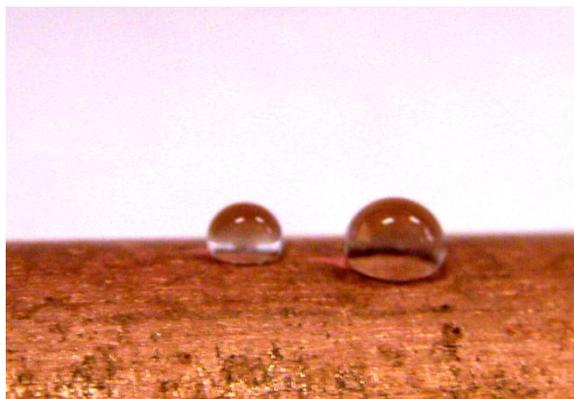
Рис 2. Капля воды на обработанной дисульфидом поверхности сплава МНЖ
