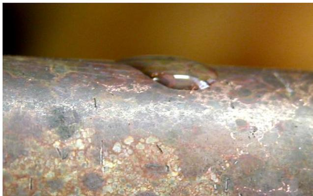
Рис 1. Капля воды на необработанной поверхности сплава МНЖ
