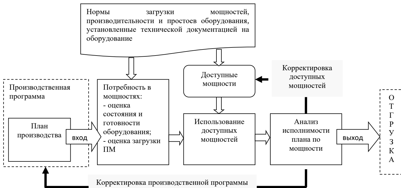
Рисунок 1 – Процесс формирования производственной программы
