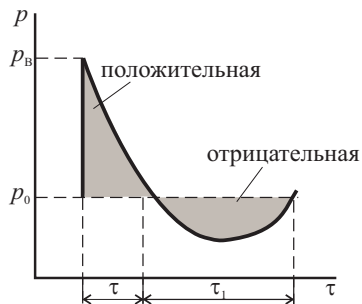
Рис. 2.24. Изменение давления в ударной волне
