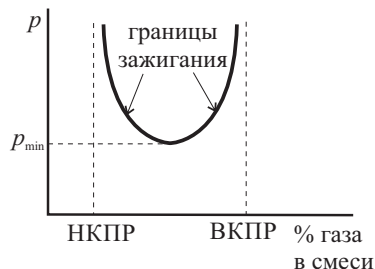
Рис. 2.11. Влияние давления на границы зажигания
