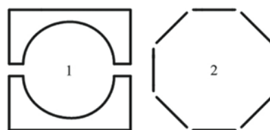
Рис. 5. Варианты фокусирующего устройства [29] для оптики (фронтальный вид): 1 – два управляющих электрода; 2 – восемь управляющих электродов
