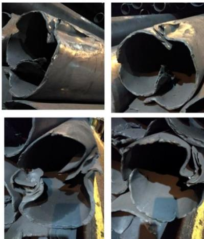
Рис. 1. Готовые трубы с концевыми складками
