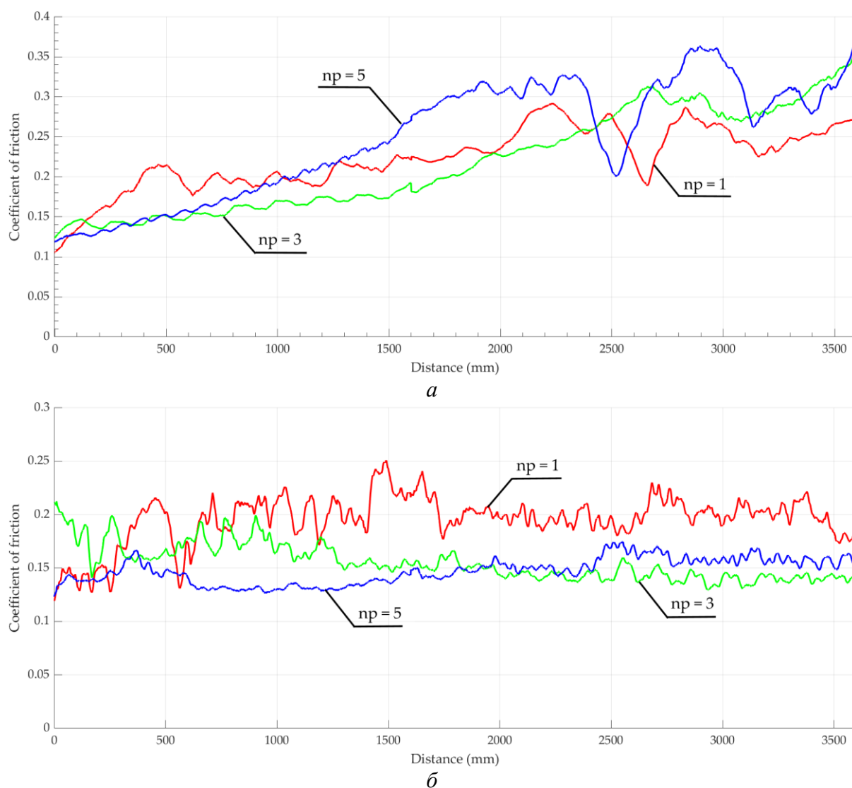
Рис. Результаты исследований коэффициента трения (COF) по схеме шар-по-диск поверхности стали AISI 304 после наноструктурирующего выглаживания: а – коэффициент сухого трения; б – коэффициент трения в условиях смазки
