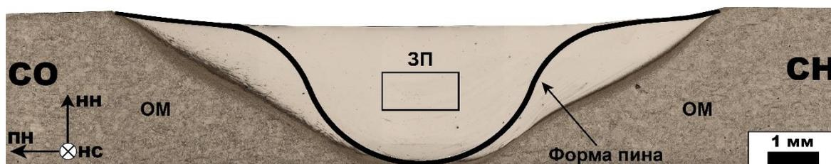
Рис. 1. Макроструктура поперечного сечения шва. ЗП – зона перемешивания, ОМ – основной материал. СО и СН соответствуют стороне отвода и стороне набегания. НС, ПН и НН - направление сварки, поперечное направление и направление нормали к плоскости свариваемых листов
