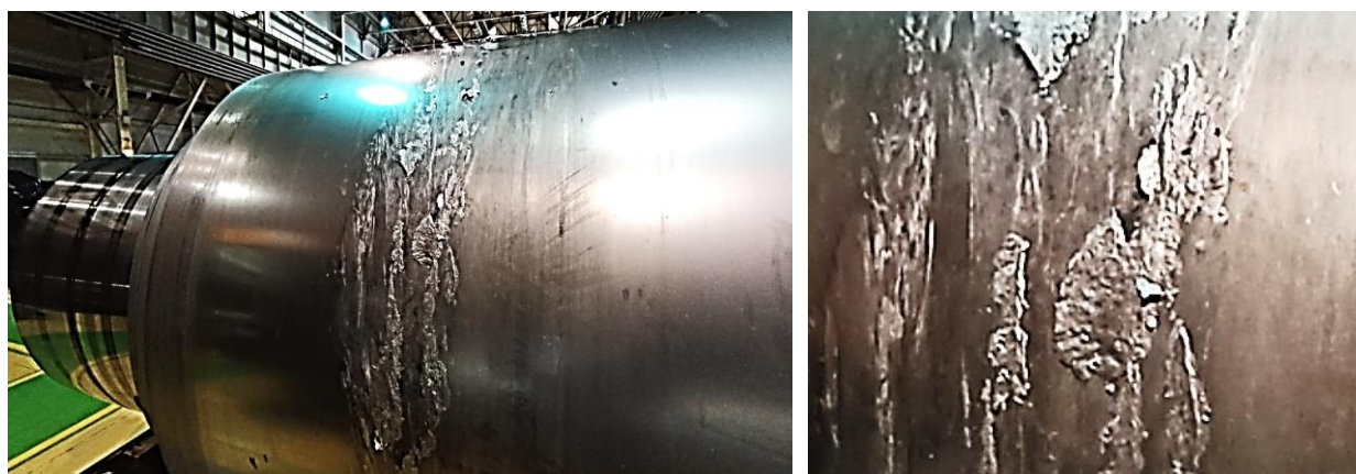
Рис. 1. Опорный валок: а – заалюминивание после окова рабочих валков; б – увеличенный фрагмент поверхности
