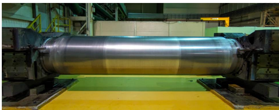
Рис. 3. Зона контакта алюминия с рабочим валком стана горячей прокатки (посередине)
