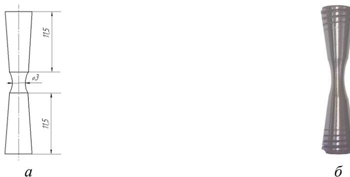
Рис. 1. — Образец для проведения усталостных испытаний: а – чертеж, б – снимок
