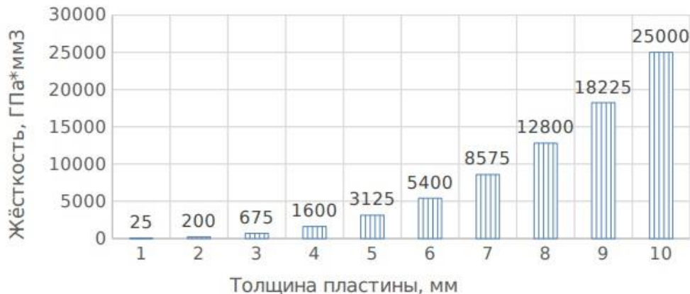
Рис. 2. Зависимость жёсткости D от толщины пластины при упругой постановке
