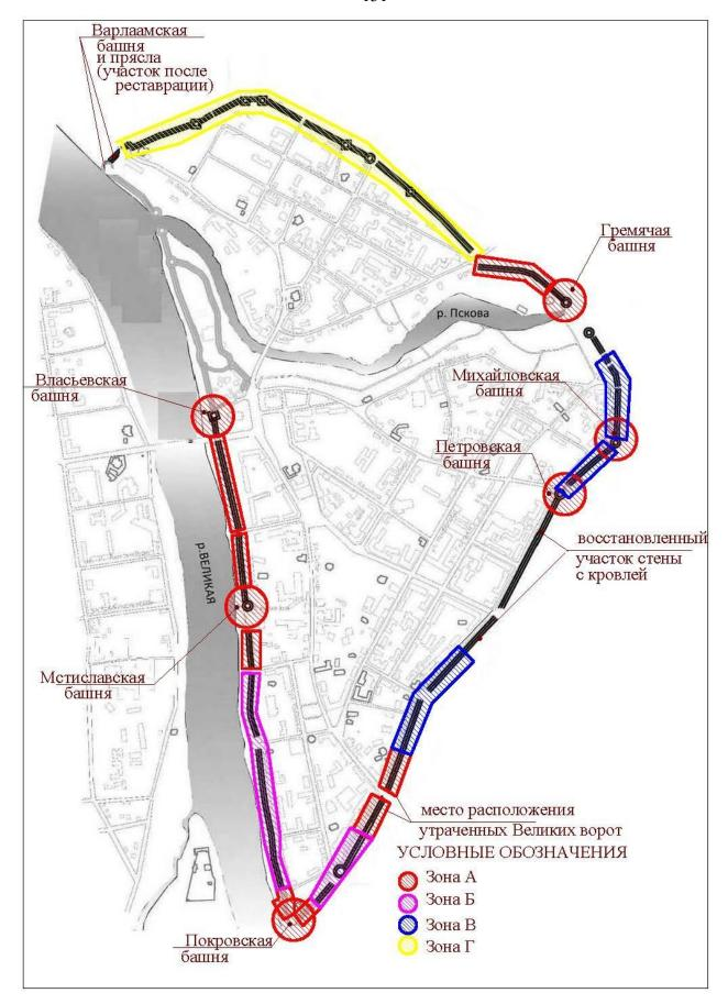
Рис. 141. Модель зонирования Окольного города по рекомендуемым видам работ по сохранению стен и башен.
