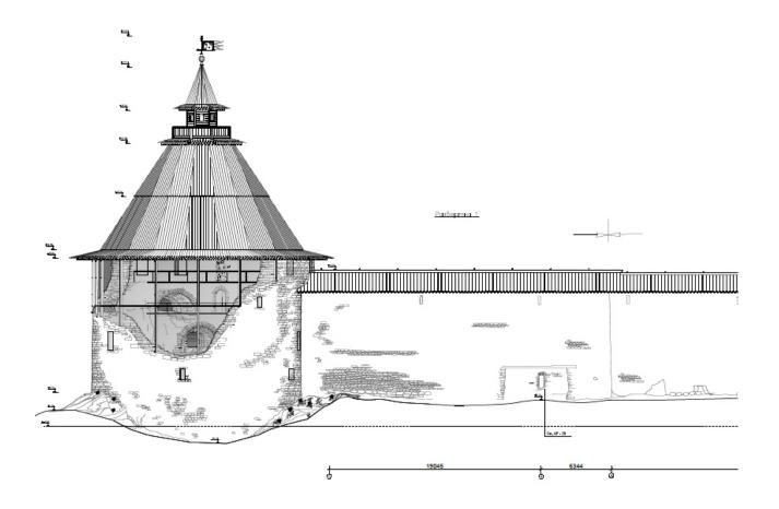
Рис. 49. Варлаамская башня и участок прясла стены вдоль р. Великая. Докомпановка утраченной каменной части планарным остеклением на металлокаркасе, воссоздание режевого шатра с тесовым покрытием. Материалы проекта ООО «АРТ-Реставрация», г. Москва.
