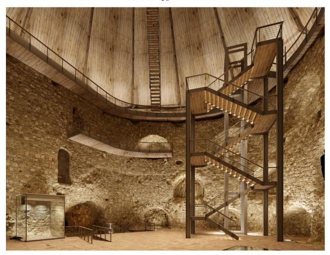
Рис. 55. Покровская башня. Организация внутреннего экспозиционного пространства — металлическая лестница на проектируемые ярусы (в форме секторов). Материалы проекта ООО «Проектное Бюро «Новый город», г. Москва.
