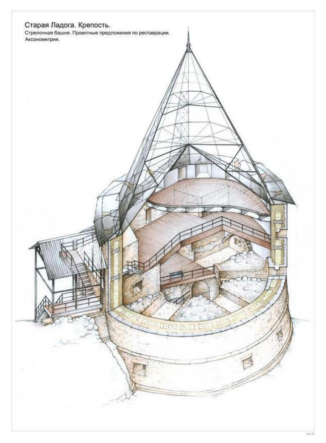
Рис. 87. Лалазаров С. В. Эскизный проект реставрации Стрелочной башни. Аксонометрический разрез. 2009 г. Материалы из сети интернет.
