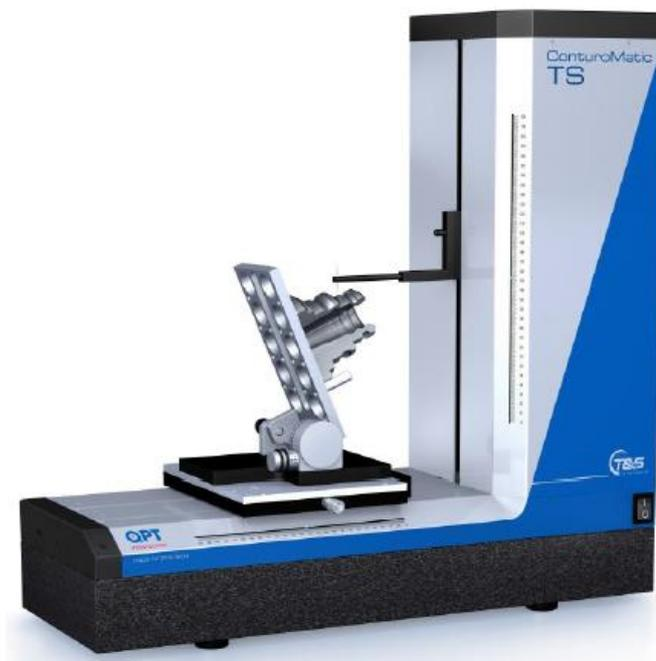
Рисунок 1 – Внешний вид контурографа ConturoMaticTS
