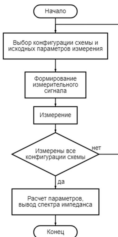
Рисунок 13 – Структурная блок-схема работы прибора «VI ImpSpec»
