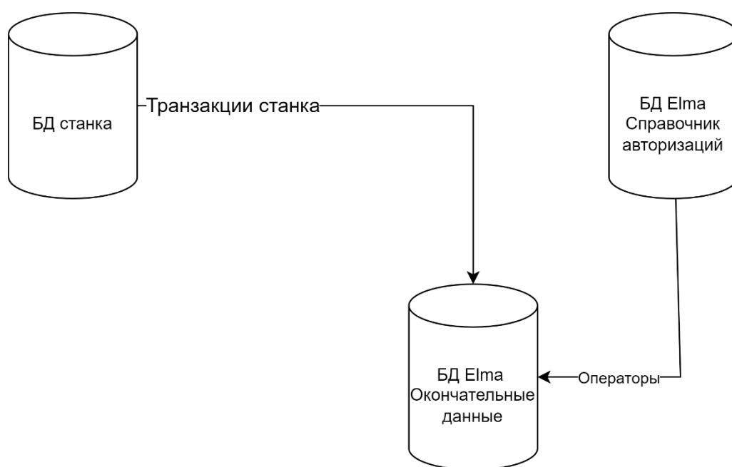
Рисунок 23. Схема сбора данных.
