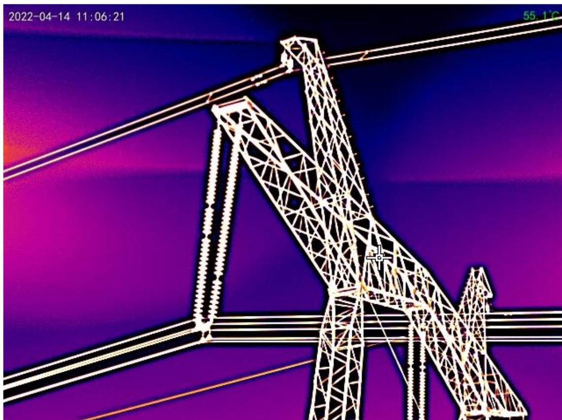
Рисунок 14 – Пример снимка опоры ЛЭП с БВС в инфракрасном спектре
