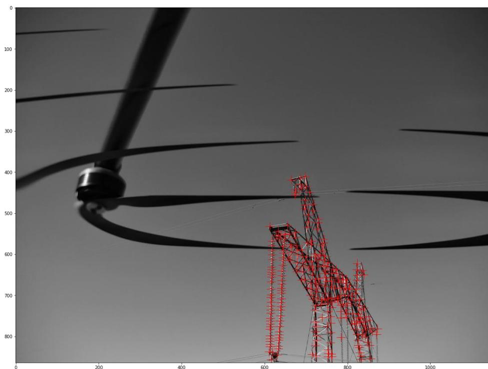
Рисунок 17 – Выделение области, занимаемой ЛЭП на снимке с помощью детектора Харриса
