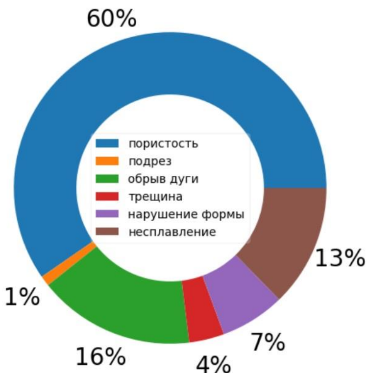
Рисунок 20 - Распределение дефектов сварных соединений по типам
