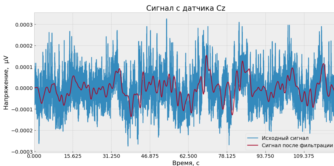
Рисунок 4 – Соотнесение исходного и фильтрованного сигнала датчика Cz
