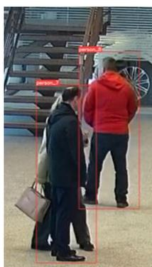
Рисунок 10 – Результат работы блока «Распознавание и трекинг людей на кадре», алгоритма распознавания лиц и проверки их на уникальность
