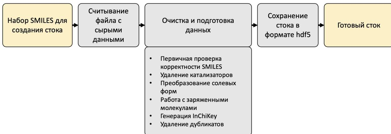
Рисунок 27 – Процесс подготовки стоков
