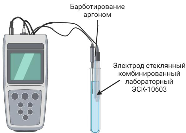
Рисунок 1 – Схема электролитической ячейки для потенциометрического титрования
