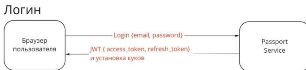
Рисунок 18 – Схема взаимодействия с JWT токеном
