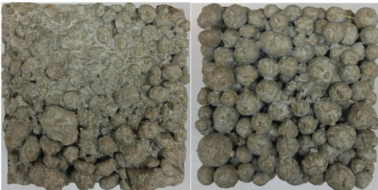
Рисунок 2.8 – Внешний вид легкого бетона на керамзитовом гравии (слева) и БЗГ (справа)
