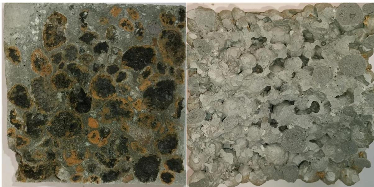
Рисунок 2.9 – Внутренняя структура легкого бетона на керамзитовом гравии (слева) и БЗГ (справа)
