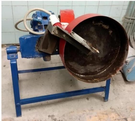
Рисунок 2.3 – Вид лабораторного тарельчатого гранулятора
