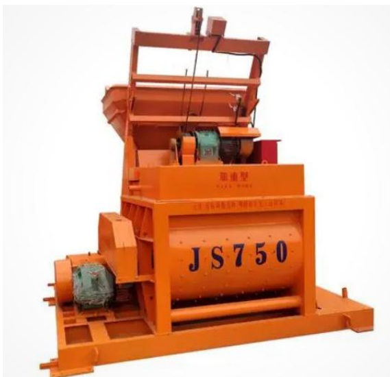
Рисунок 3.8 – Принудительная бетономешалка JS750
