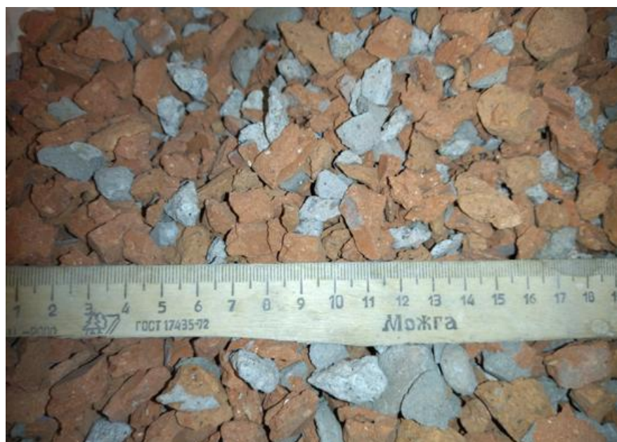
Рисунок 2.9 – Внешний вид фракции 5-20 мм после дробления
