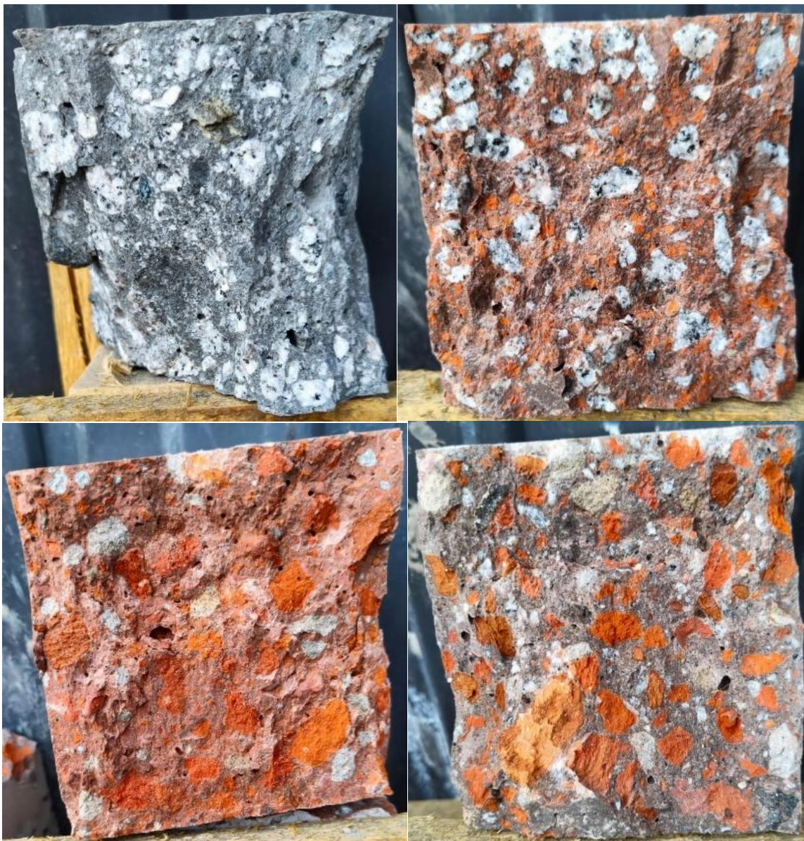
Рисунок 2.11 – Внутренне строение бетонных образцов состава №1 (слева сверху), состава №2 (справа сверху), состава №3 (слева снизу) и состава №4 (справа снизу) с пластифицирующей добавкой после испытания на сжатие
