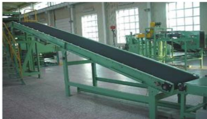
Рисунок 3.14 — Ленточный конвейер 650 мм
