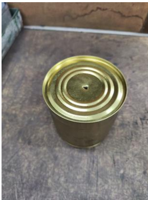
Рис. 1. Металлический контейнер объёмом 420 см 3 , наполненный замасленной окалиной
