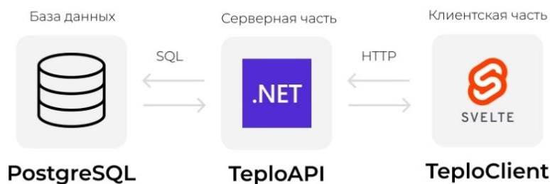
Рис. 1. Архитектура информационно-моделирующей системы теплового режима доменной плавки
