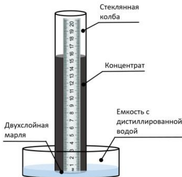
Рис. 1. Схема установки для определения комкуемости
