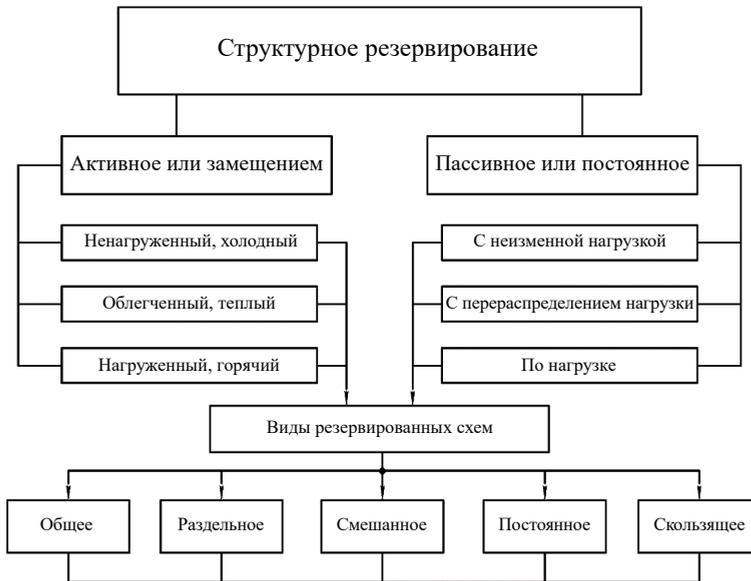
Рис. 4.3. Виды структурного резервирования
