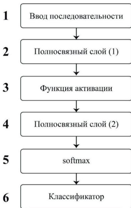
**Рис. 6.** Архитектура полносвязной нейронной сети в задаче определения типа ПРЦ, представленной центральной вектор-строкой
