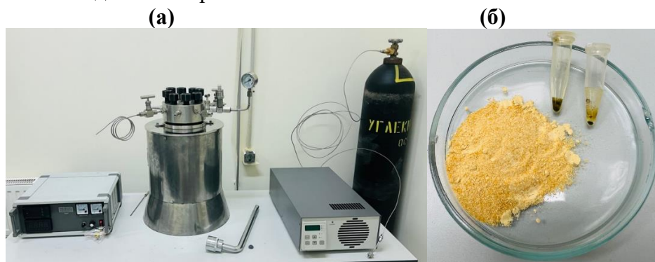
Рис. 1. (а) Установка для экстракции сверхкритическом \text{CO}_2 и (б) полученный образец экстракта из кожуры дыни
