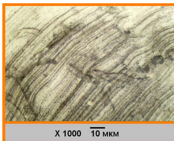
Рис. 2. Поперечные сечение осадка кремния полученного электролизом расплава \text{KF}(40,1)\text{-KCl}(49,0)\text{-K}_2\text{SiF}_6(9,9)\text{-KI}(1,0)\text{-SiO}_{2(\text{ненас.})} ( i_k = 0,02 \text{ A/cm}^2 , T = 973 \text{ K} )
