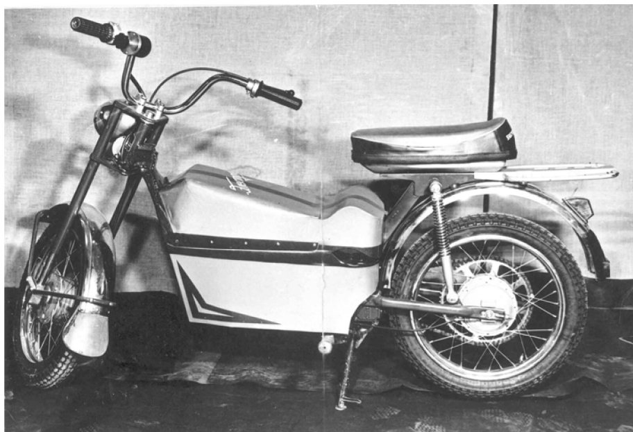
Рис. 2. Мотороллер на цинк-воздушных ХИТ (Львовский мотороллерный завод)
