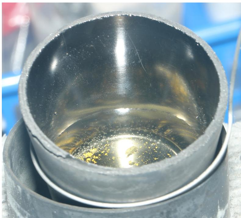
Рисунок 2. Фотография расплава с осадком оксифторида церия.
