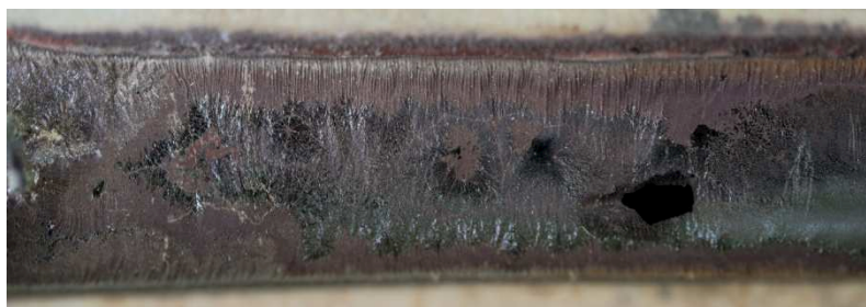
Рисунок 3. Игольчатые кристаллы на границе алунд - шлак после обработки шлака газовой фазой.
