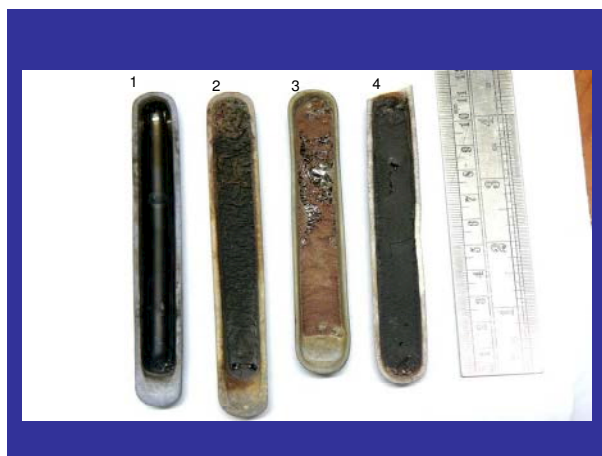
Рисунок 1. Вид поверхности шлака после обработки расплава газовой фазой различного состава.
