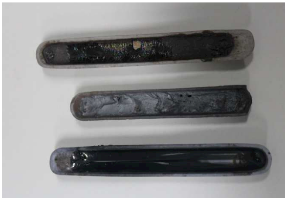
Рисунок 2. Вид поверхности шлака после обработки расплава аргонном (средняя лодочка).
