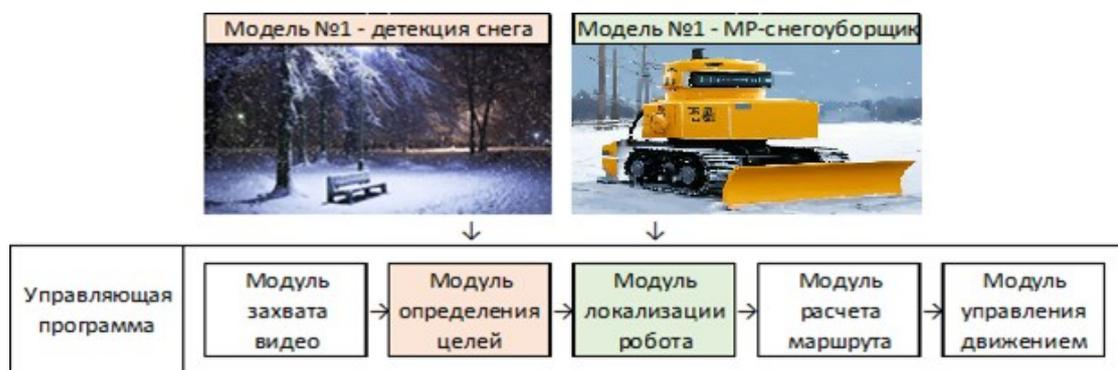
Рисунок 2 – Подключение моделей к управляющей программе
