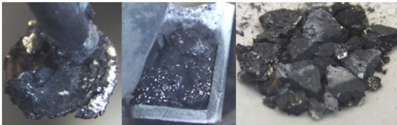
Рисунок 3. Катодный узел (молибден, тигель  $\text{MgO}$  и восстановленный  $\text{ZrO}_2$ ) после электролиза расплава  $\text{LiCl-KCl-Li}_2\text{O}$  при температуре  $650^\circ\text{C}$
