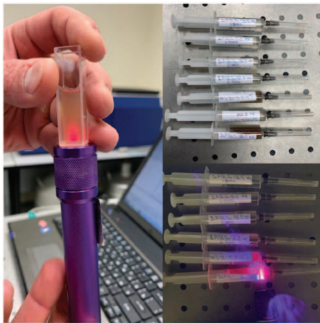
Рис. 4. Образцы приготовленных растворов с разным содержанием КТ InP/ZnSe/ZnS 650. При прохождении ультрафиолетового луча через кювету с 0,01 % раствором КТ InP/ZnSe/ZnS 650 происходит флуоресценция в видимом спектральном диапазоне
