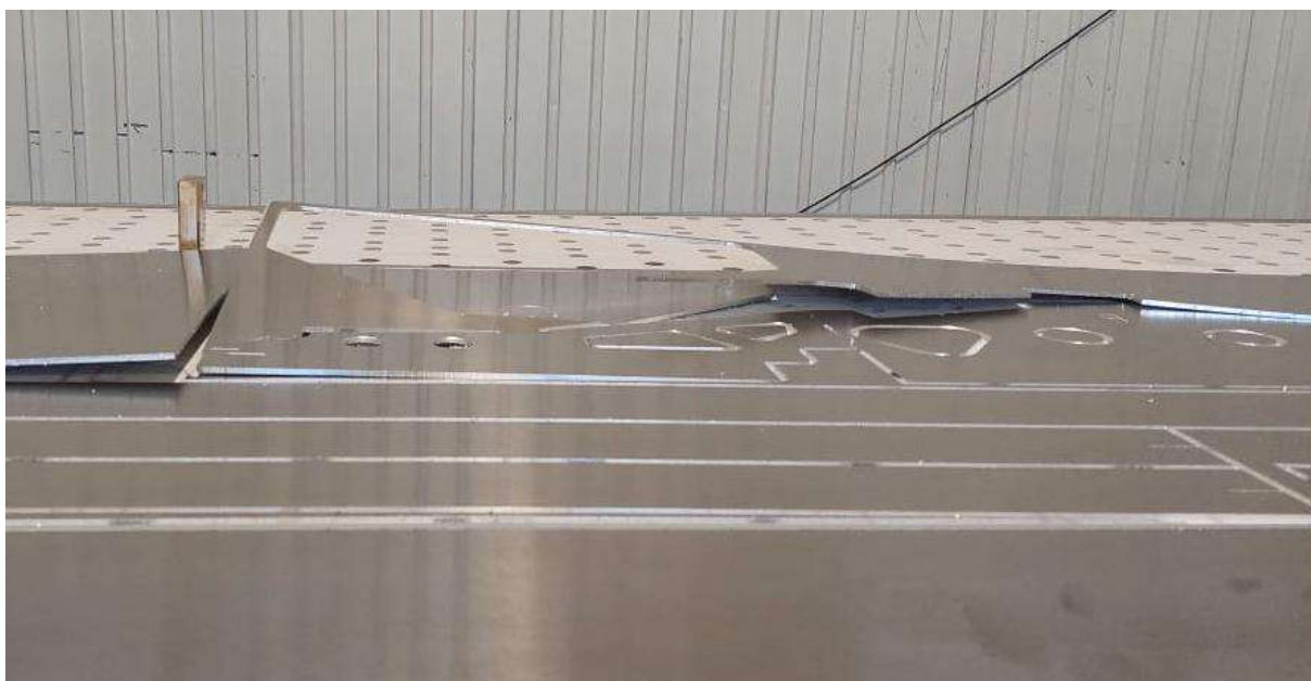
Рис. 1. Потеря плоскостности листа 5083 H111 толщиной 4 мм после резки
