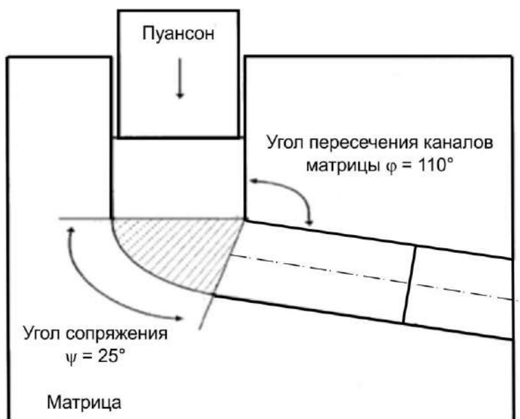
Рис. 1. Схема каналов в установке РКУП при прессовании прутков сплавов системы Ti-Nb-Zr
