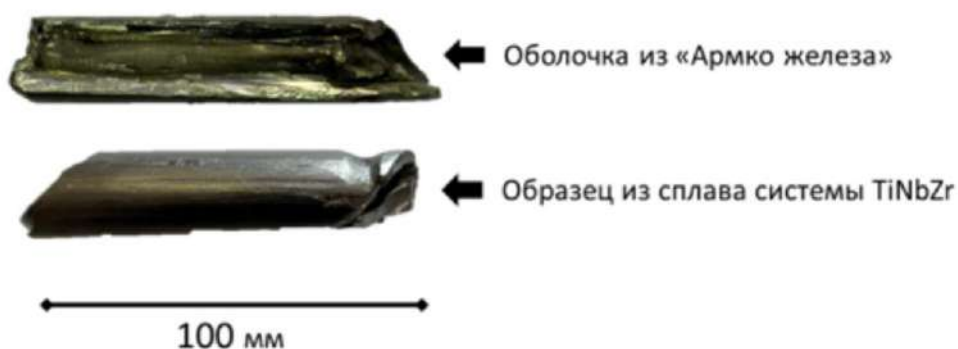
Рис.2. Фото оболочки и образца после проведения РКУП
