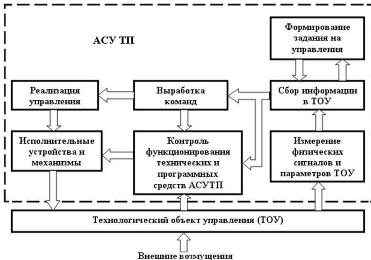
Рисунок 1- Схема функционирования АСУТП
