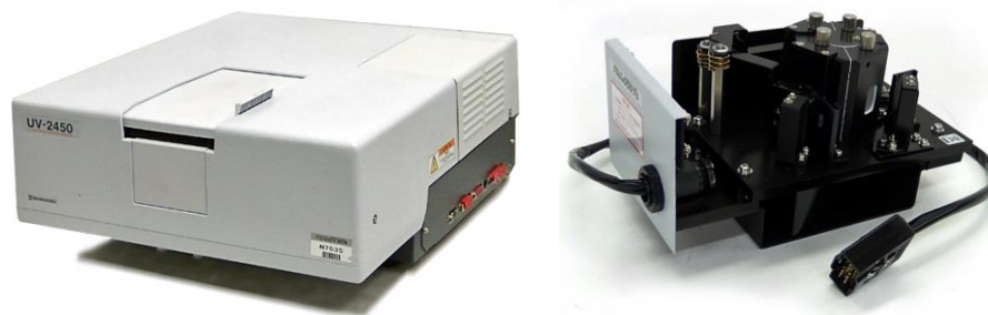
Рисунок 2.5 – Внешний вид спектрофотометра Shimadzu UV-2450 (слева) и интегрирующей сферы ISR-2200 (справа)
